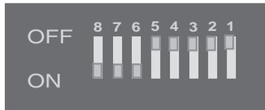
Ponga el contacto 6 del Interruptor DIP en posición de encendido (ON).
